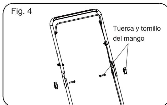
**IMPORTANTE:** Despliegue el mango con cuidado de no se pellizque ni se dañe el cable Bowden.
