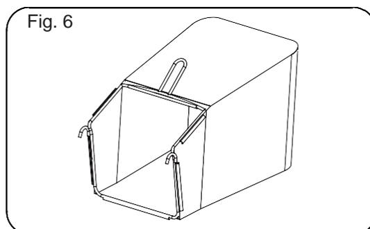
1. La bolsa colectora de hierba se suministra semimontada. Asegúrese de que el asa del marco esté fuera de la parte superior de la bolsa.
