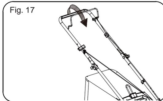
Suelte la barra de control de encendido/apagado del motor. Regresará a la posición inicial y el motor se apagará automáticamente.
