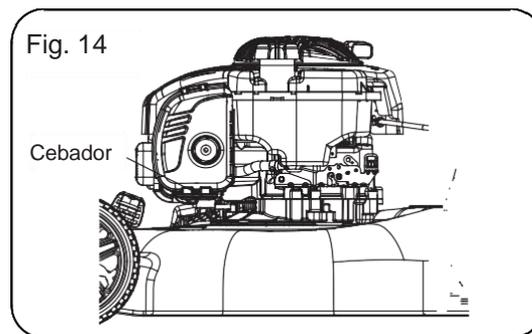
2. Colóquese detrás del cortacésped. Tire de la barra de control de encendido/apagado del motor hacia el mango superior con una mano, y coloque la otra mano sobre el mango de arranque del motor.
