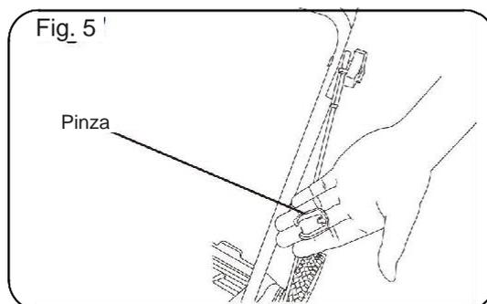
Sujete el cable Bowden al mango inferior utilizando la pinza para el cable (incluida).
