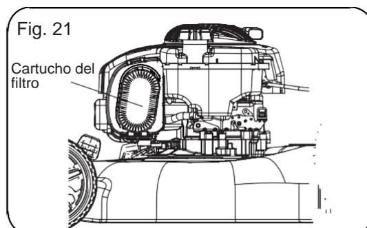
Si el filtro de aire está sucio, se reduce el rendimiento del motor debido a la restricción del aire al carburador. Si el aire contiene mucho polvo, será necesario comprobar con más frecuencia el filtro de aire.
